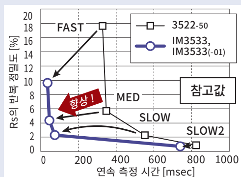
C-D와 ESR 측정 (100kHz)의 연속 측정 시 연속 측정 시간과 Rs의 반복 정밀도 (샘플: 알루미늄 전해 콘덴서 1.5 \mu F)
